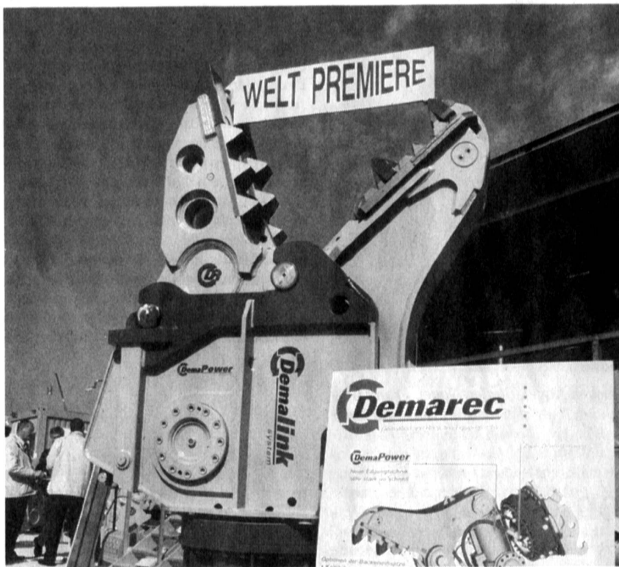
Das Gerät ist zugleich Pulverisierer, Kombischere oder Schrottschere.
